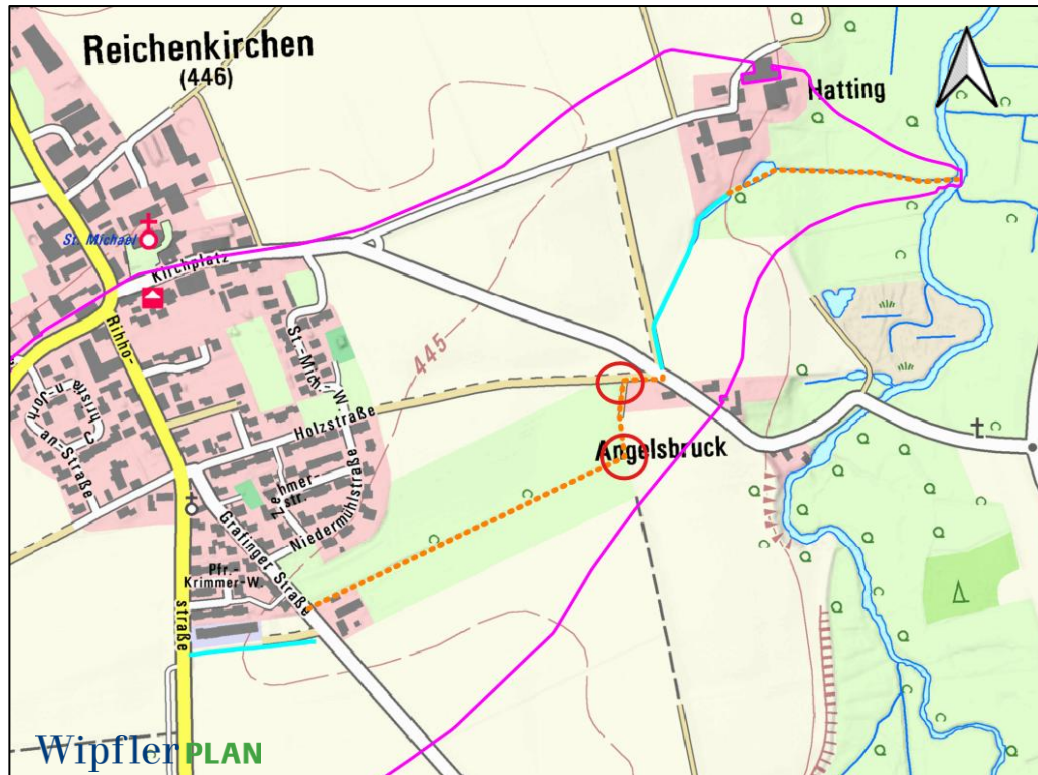
Abbildung 4-3: Graben auf Grundlage von Vermessung (hellblau) und DGM1 (orange gestrichelt) sowie Lage der angenommenen Durchlässe (rot eingekreist) innerhalb des Modellumgriffs (pink) (Quelle Hintergrundkarte [4])
